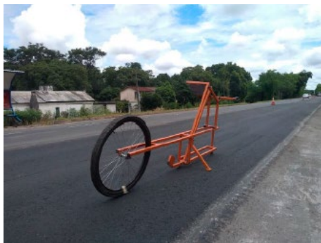
IRI 측정에 사용되는 장비 현장에서 흔히 사용되는 머린(Merlin)
